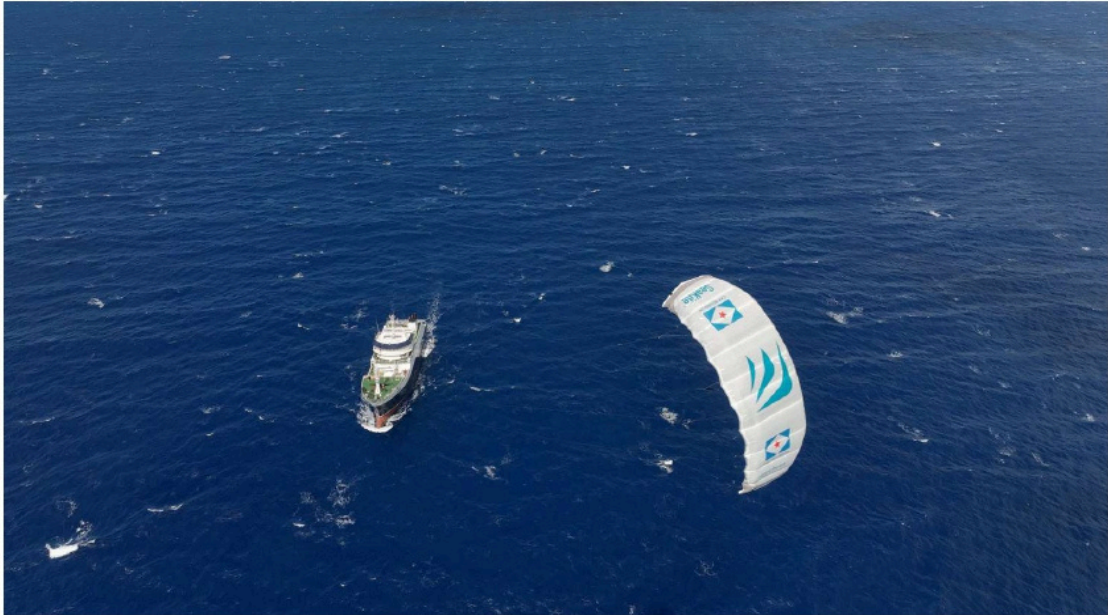
Le navire de pêche Cap Kersaint équipé d'un système SeaKite® de 100m²- Crédit ©Jérôme Balleydier
