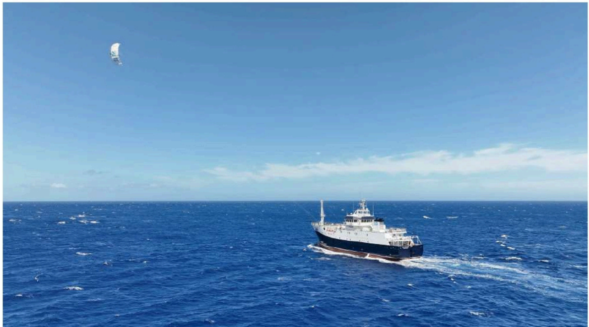
Le navire de pêche Cap Kersaint équipé d'un système SeaKite® de 100m 2 - Crédit ©Jérôme Balleydier
